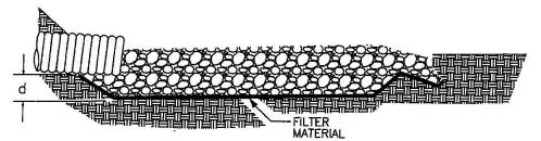
THICKNESS (d) =  $1.5 \times MAX$  ROCK DIAMETER (6" MIN)
